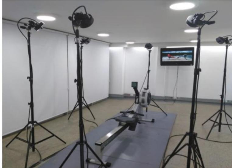
**Figura 2. Equipo de captura de datos y máquina Concept 2, modelo D PM5.**
