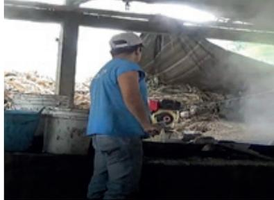
Figura 11. Operación de retiro de limpieza y descachazado
